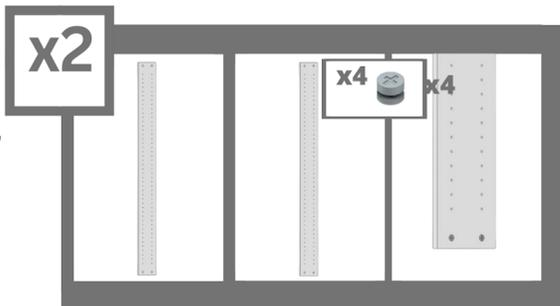
Pegar uma lateral, colocar ela "de lado" com a fita de borda virada para o chão e encaixar os tambores Minifix nos furos, conforme a imagem.
