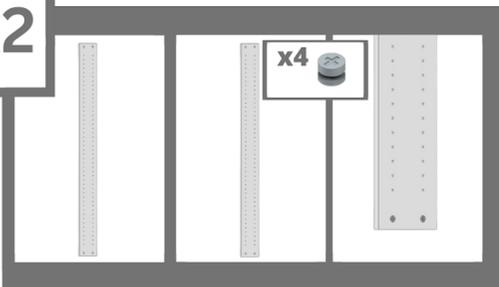
Pegar um Lateral, colocar ele "de lado" com a fita de borda virada para o chão e encaixar os Tambores Minifix nos furos, conforme a imagem.
