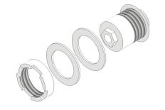
Para a montagem da fechadura, primeiro solte a porca grande da rosca da fechadura e retire-a. Insira 01 (um) anel de borracha até ele encostar na parte frontal da fechadura.
