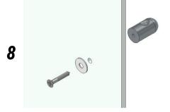
Para a instalação do puxador é necessário o posicionamento do parafuso com a arruela plástica de um lado do vidro e o do outro lado o puxador. Após o posicionamento, a fixação é feita com o aperto de parafuso.
