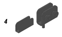
Insira o "U" plástico no interior da dobradiça cuidando para que o pino desta peça entre no furo da ponta da dobradiça. Se necessário, ajustar o alinhamento da porta com o nicho da estante afrouxando um pouco os parafusos das dobradiças e puxando ou empurrando a porta dentro da dobradiça - fazer isso iniciando no tampo e depois na base, um por vez, para não correr o risco da porta desencaixar e cair.
