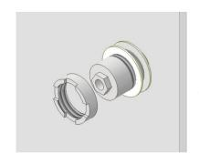
Insira o outro anel de borracha e logo após a porca grande. Fixe a fechadura rosqueando à porca grande até que ela fique bem firme. Pode ser que a borracha deforme um pouco, mas isto é normal.
