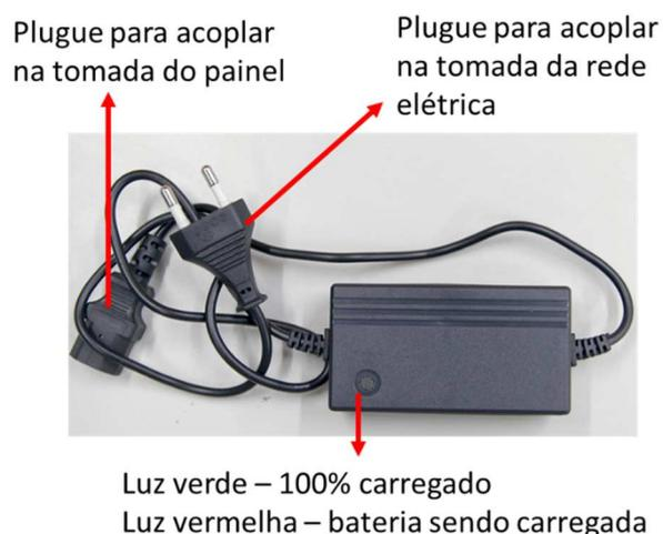
A bateria após estar completamente carregada poderá fornecer energia por várias horas de trabalho. A autonomia da carga depende de vários fatores, principalmente da pressão utilizada no equipamento. Quanto maior a pressão, maior o consumo.
