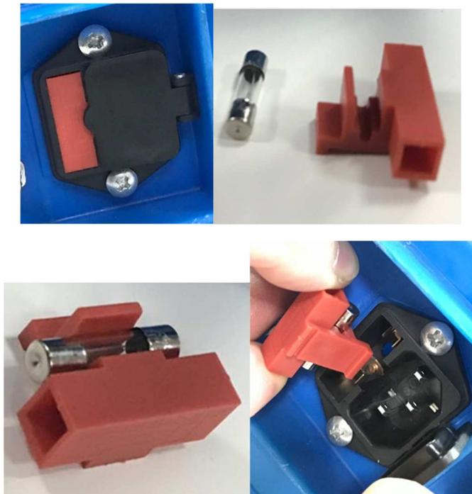
Caso o fusível não seja montado ou esteja queimado no equipamento, o mesmo não irá permitir o funcionamento da bomba elétrica.
