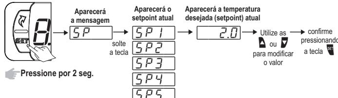
Se o controlador estiver configurado para operar no modo avançado, em seguida será exibida a mensagem [SP-E] indicando o ajuste do setpoint econômico. Novamente utilize as teclas ▲ ou ▼ para modificar o valor e confirme pressionando [SET].
