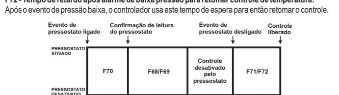
NOTA 1: Ao terceiro evento de pressão alta ou baixa, no intervalo máximo de uma hora ao inicializar o controlador, o sistema exibe a mensagem  RPL0 - Alarme de pressostato de baixa, do qual requer que o sistema seja rearmado manualmente. Para isso, acesse o menu rápido, via tecla  4, conforme capítulo 6, selecione  HPLP e pressione com toque curto a tecla  5 para selecionar.
